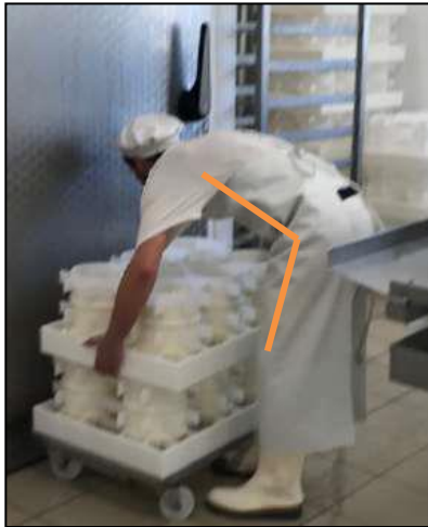
Figure 7 : étape 2, stockage des bloc-moules pleins (35KG)
