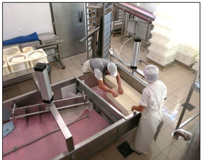
Figure 23 : Prise des blocs de caillé pour moulage
